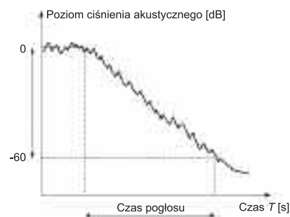
Rys. 4. Spadek poziomu ciśnienia akustycznego i czasu pogłosu w pomieszczeniu po wyłączeniu źródła dźwięku
