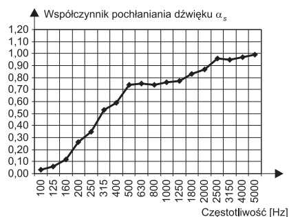
Rys. 6. Charakterystyka pogłosowego współczynnika pochłaniania dźwięku dla próbki materiału dźwiękochłonnego zmierzona w komorze pogłosowej
