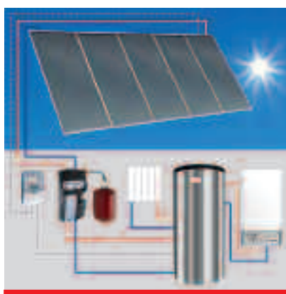
Pakiet systemu Premium – schemat połączeń systemu solarnego do podgrzewania wody użytkowej i wspomagania CO
