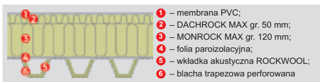
Rys. 1. Przekrój dachu budynku Pentair-Schroff w Dzierżonowie
