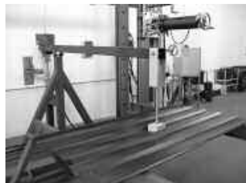
Badania wytrzymałości na obciążenie skupione wg PN-EN 14782:2008 Fot. arch. ITB
