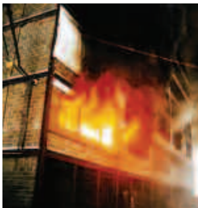
Fot. 2. Test ogniowy ośmiopiętrowego budynku w Cardington (1997)
