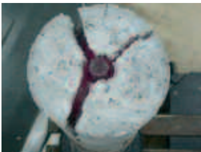
Fot. 1. Badanie „na zimno” – przykład typowego zniszczenia, stal A, temp. 700 °C
