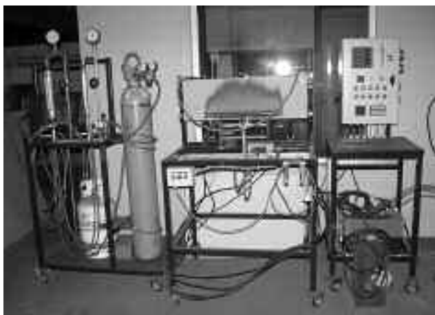
Fot. 1. Widok stanowiska do badania ciągłości obwodu wg PN-EN oraz PN-IEC Fot. arch. ITB
