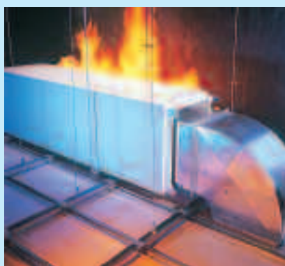
Obudowa kanału wentylacyjnego K 271
