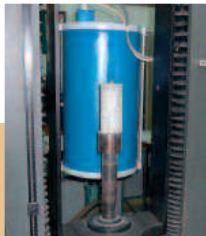
Fot. 2. Badanie „na gorąco” – widok próbki przed badaniem. W tle cylindryczny piec, w którym umieszczana jest próbka
