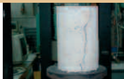
Fot. 3. Badanie „na gorąco” – przykład typowego zniszczenia, stal C EPSTAL®, obciążenie 12 kN
