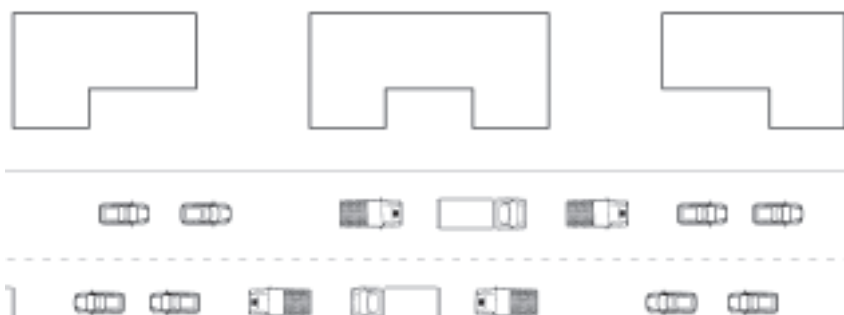
Rys. 1. Kształt bryły budynku, który może powodować podwyższenie poziomu hałasu przy elewacji w stosunku do budynku zaprojektowanego na rzucie prostokąta [11]
