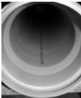
Fot. 4. Wnętrze rury z PVC do budowy przepustu. Widoczna gładka powierzchnia wnętrza rury [17]
