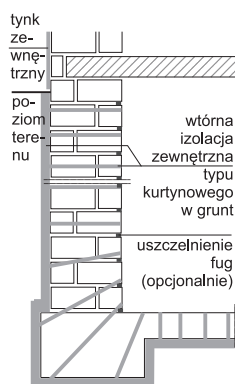
Rys. 3. Schemat wykonania izolacji kurtynowej [Rys. M. Rokiel]
