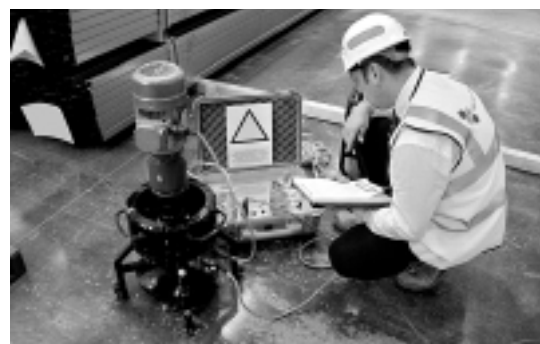
Fot. 2. Badanie ścieralności posadzki w warunkach rzeczywistych za pomocą urządzenia BCA [6]
