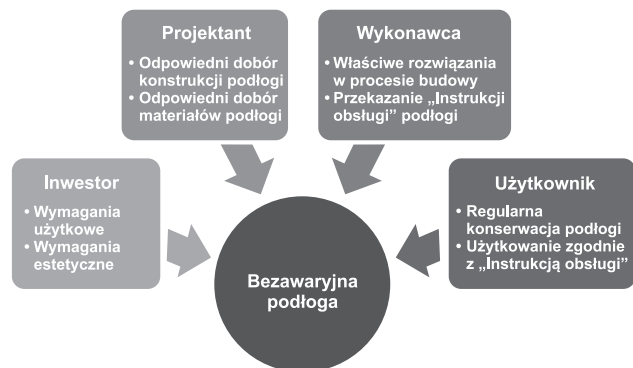
Rys. 1. Kryteria doboru odpowiedniego rozwiązania podłogi
