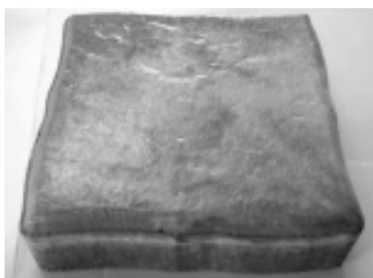
Fot. 3. Wibroprasowana kostka brukowa wykonana z odciskiem powierzchni strukturalnej z zabezpieczoną powierzchnią w technologii nakładania
