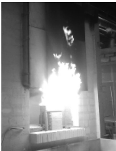
Fot. 2. Badanie ściany zewnętrznej budynku pod kątem odpadania elementów elewacji w przypadku pożaru
