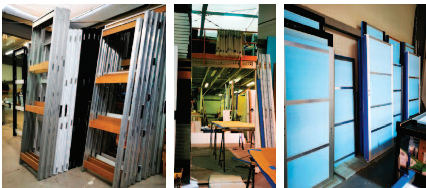
Fot. 3. Ościeżnice i skrzydła drzwiowe na różnym etapie wykończenia, z różnymi materiałami wykończeniowymi, podczas weryfikacji możliwości wytworzenia w różnych skrajnych i pośrednich wymiarach
