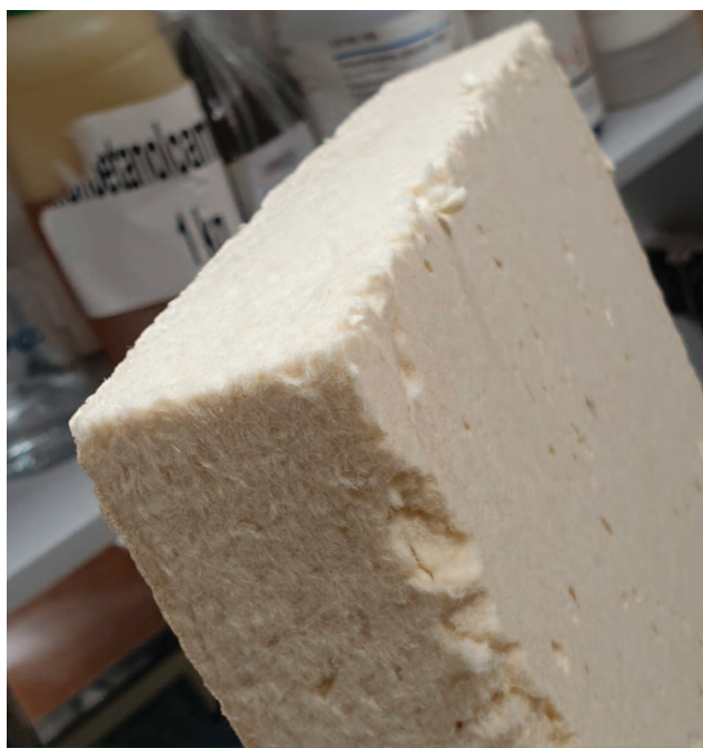
Lekka, ognioodporna płyta wytworzona z włókien drzewnych inkrurowanych boraksem
