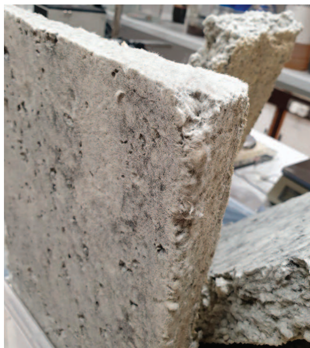
Lekka, ognioodporna płyta wytworzona z włókien drzewnych inkrurowanych grafitem ekspandującym
