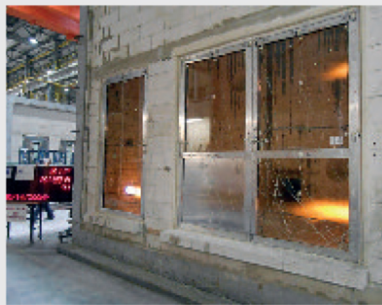
Drzwi ASP 80 FIRE w trakcie badania
