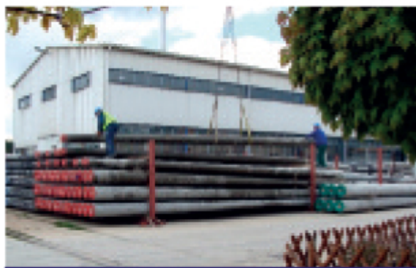
Fot. 1. Pierwsza hala produkcyjna i strunobetonowe żerdzie wirowane typu E w Kuzkach
