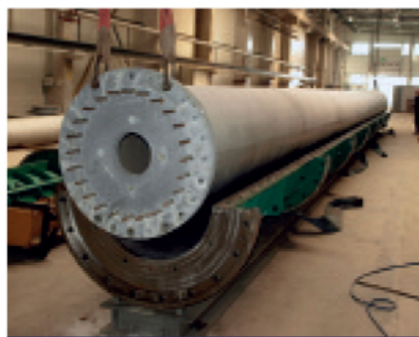
Fot. 9. Segment strunobetonowej wieży wyjmowany z formy rozbiegającej
