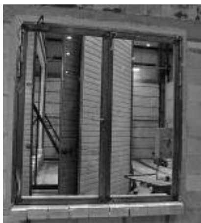
Fot. 2. Drzwi stalowe, dwuskrzydłowe, profilowe, przeszklone Photo 2. Steel double leaf glazed profiled door set
