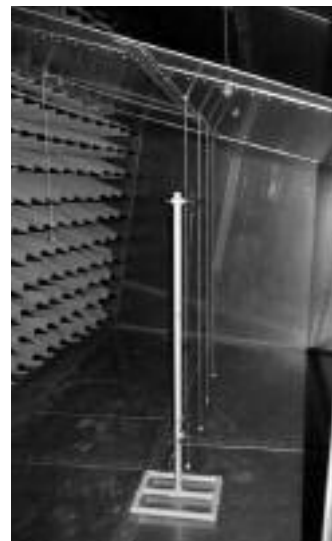
Wnętrze komory GTEM 2000
