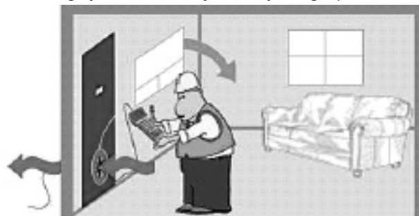
Rys. 2. Poglądowy schemat badania szczelności powietrznej
