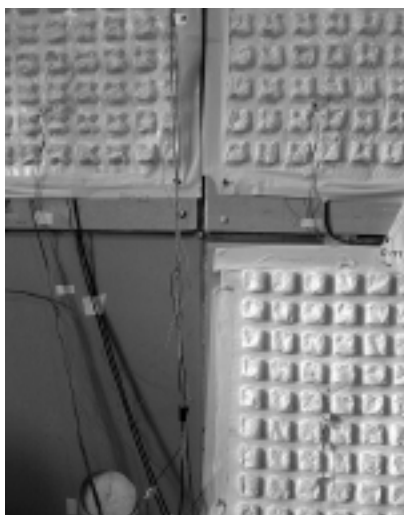
Fot. 2. Druga dodatkowa warstwa mocowana na płytach gipsowo-kartonowych (PCM w postaci skoncentrowanej umieszczonej w zagłębieniach folii)
