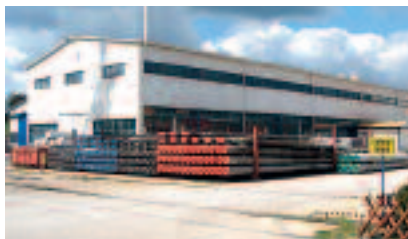
Fot. 1. Hala produkcyjna i strunobetonowe żerdzie wirowane typu E w Kuzkach Photo 1. The production hall and prestressed spun-concrete poles type E in Kuzki
