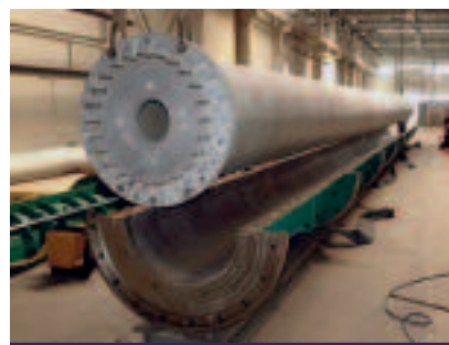
Fot. 9. Człon strunobetonowej wieży wyjmowany z formy rozbieralnej Photo 9. Member prestressed concrete tower during removal from the separable cast
