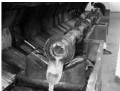
Fot. 3. Forma w wirówce rolkowej Photo 3. Moulds in roller centrifuge
