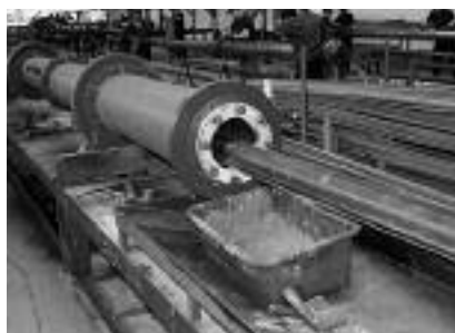
Fot. 2. Napełnianie formy betonem Photo 2. Filling of mould with concrete
