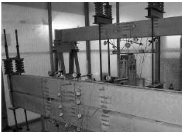
Fot. 2. Belki na stanowisku do obciążeń długotrwałych Photo 2. Beams on the test setup under sustained load
