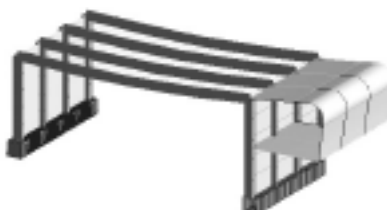
Rys. 1. Schematyczny układ konstrukcji dachu wraz z podcieniem przyjęty do obliczeń Fig. 1. Computation schematic layout of the roof structure together with an arcade
