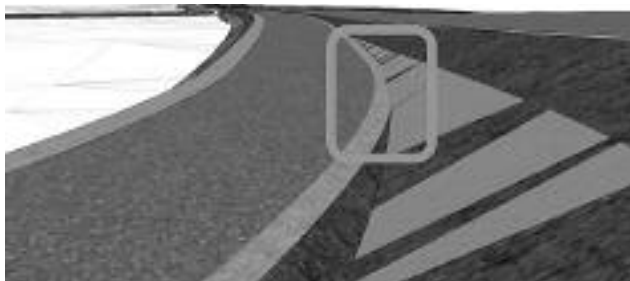
Rys. 2. Przykładowa kolizja pomiędzy jezdnią a nasypem widoczna w modelu 3D
