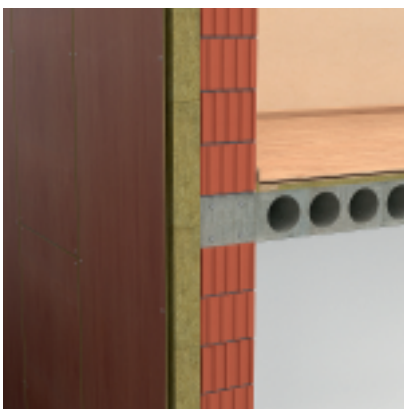
Ocieplenie ściany zewnętrznej skalną wełną VENTI MAX pod okładzinę z płyt ROCKPANEL
