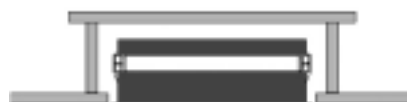
Rys. 3. „Skrzynka ogniowa” – zestaw elementów z wełny mineralnej do obudowy lamp i podobnych elementów, zamontowanych w suficie podwieszonym
