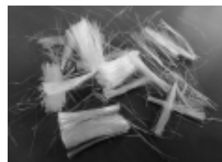
Mikrowłókna polipropylenowe użyte do betonu wysokowartościowego
