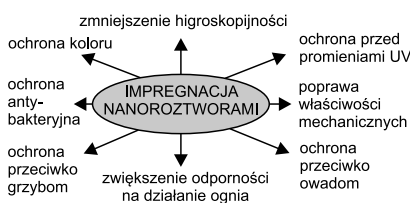
Rys. 2. Możliwości zmiany właściwości drewna dzięki impregnacji nanoroztworami
