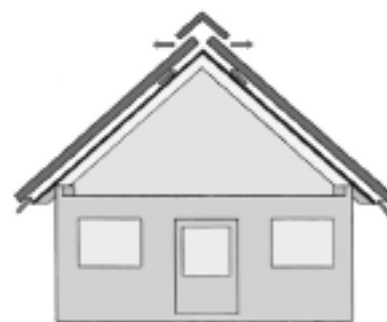
Rys. 6. Dach niewentylowany z pokryciem wentylowanym
