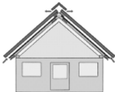
Rys. 4. Dach wentylowany z pokryciem wentylowanym
