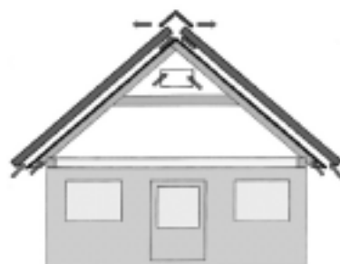
Rys. 1. Dach wentylowany z pokryciem wentylowanym
