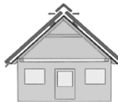
Rys. 3. Dach niewentylowany z pokryciem wentylowanym
