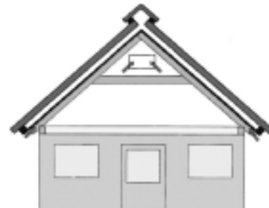
Rys. 2. Dach wentylowany z pokryciem niewentylowanym
