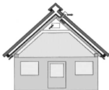
Rys. 5. Dach wentylowany z pokryciem niewentylowanym
