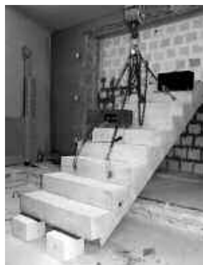
Fot. 2. Widok modelu fragmentu klatki schodowej do badań elementów z izolacją akustyczną stosowanych przy oparciu biegu schodowego na podestzie
