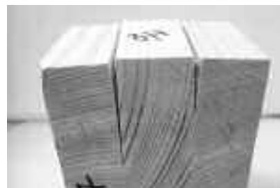
Fot. 1. Przykład zachowania się spoin klejowych po teście delaminacji w półfabrykatach o niezalecanym kącie nachylenia przyrostów rocznych
