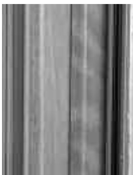
Fot. 10. Ukośny przebieg włókien (baranowatość – w meblarstwie jest to bardzo pożądana cecha meranti)
