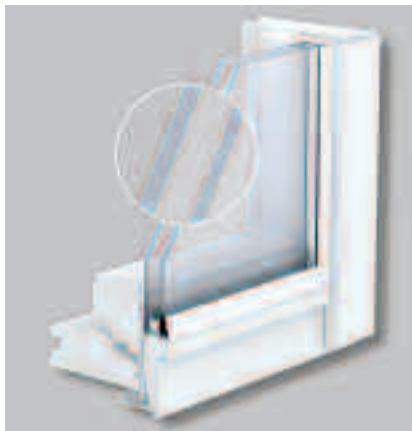
Fot. 1. Okno z szybą bezpieczną z powłoką łatwo zmywalną – 73: grubość pakietu szybowego 24 mm; szyba zewnętrzna hartowana float 4 mm; przestrzeń między szybami gr. 14 mm wypełniona argonem; szyba klejona wewnętrzna gr. 2 x 3 mm z folią
