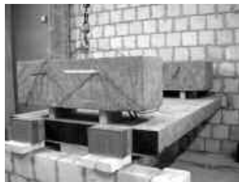
Fot. 1. Widok modelu fragmentu klatki schodowej do badań elementów z izolacją akustyczną stosowanych przy mocowaniu podestu w ścianie; na zdjęciu widoczne są bloki żelbetowe obciążające podest podczas przeprowadzania badań
