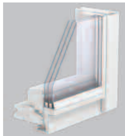
Fot. 2. Okno z szybą dwukomorową – 65: grubość pakietu szybowego 32 mm; szyba zewnętrzna hartowana float gr. 4 mm; przestrzeń między szybami gr. 10 mm wypełniona kryptonem; szyba środkowa hartowana float gr. 4 mm; przestrzeń między szybami 10 mm wypełniona kryptonem; szyba wewnętrzna klejona gr. 2 x 2 mm z warstwą folii
