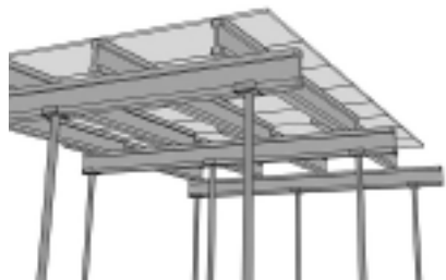
Przykładowy schemat szalunku podporowego
