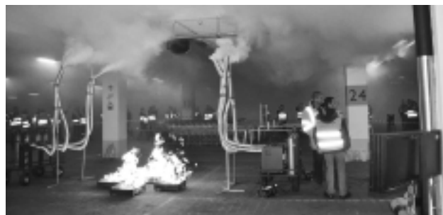
Próby z gorącym dymem w garażu podziemnym
