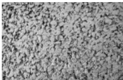
Fot. 1. Makrotekstura powierzchni warstwy z mieszanki SMA
