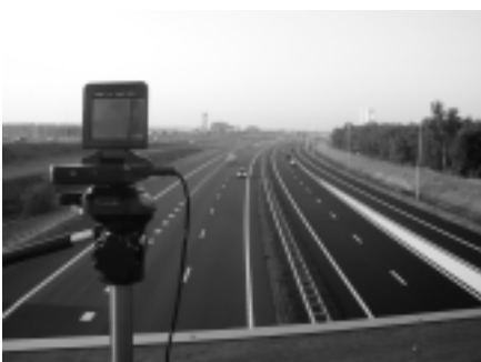
Fot. 2. Usytuowanie urządzenia do pomiaru natężenia ruchu
