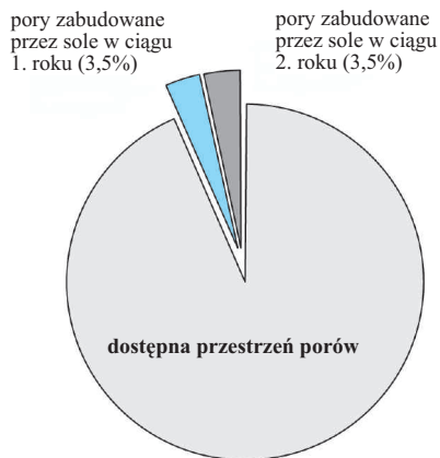
Rys. 3. Wyniki postępu gromadzenia soli w systemie tynków renowacyjnych na ścianie testowej na wysokości 10 cm (po dwóch latach)
