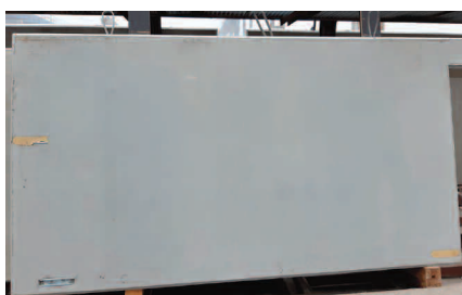
Fot. 2. Prefabrykat bez przebarwień dzięki zastosowaniu MasterSURE
