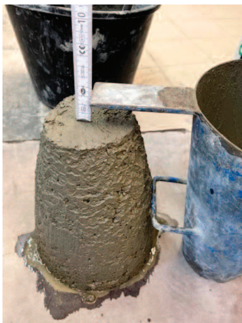
Fot. 2. Badanie konsystencji mieszanki B75PK – metoda opadu żożka Photo 2. Testing the consistency of the B75PK mix – slump test
