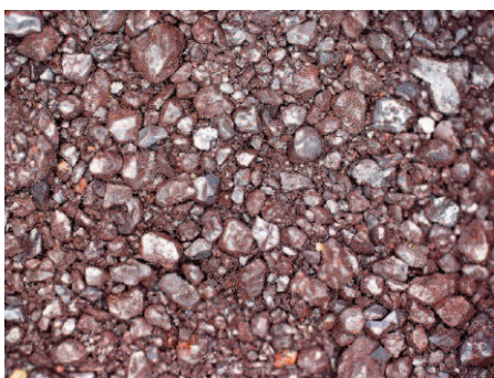
Fot. 1. Odpadowy piasek korundowy (PK) Photo 1. Waste corundum sand (PK)
