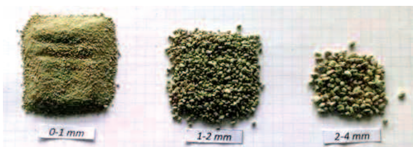
Fot. 4. Wydzielone z narzutu tynku frakcje wypełniacza 0 – 1 mm, 1 – 2 mm i 2 – 4 mm Photo 4. Filler fractions separated from the render coat: 0 – 1 mm, 1 – 2 mm and 2 – 4 mm
