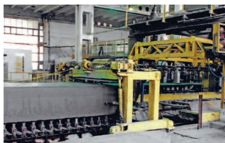
Fot. 9. Krojenie bloku masy (krajalnicą klawiszową) w ZBK w Kozienicach (1976 r.)
