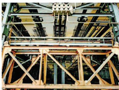
Fot. 10. Zautomatyzowana linia powlekania siatek zbrojeniowych powłoką antykorozyjną w zakładzie betonu komórkowego w Puławach
