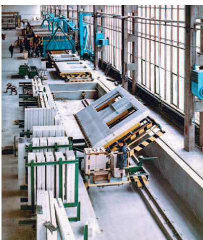
Fot. 11. Widok ogólny linii technologicznej scalania i fakturowania w ZBK w Puławach (1973 r.)
