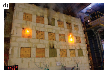
Fot. 4. Próbkę przed badaniem odporności ogniowej (a) oraz w 17 min badania (b); w 61 min badania (c) i po 90 min badania odporności ogniowej (d)
