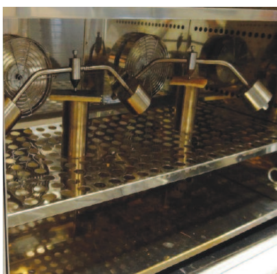
Fot. 7. Stanowisko badawcze do określania temperatury ugięcia powłoki laminatowej pod obciążeniem skupionym
