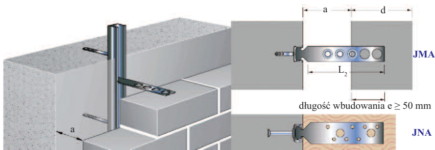
Fot. 8. Połączenie ściany murowanej i elementu prefabrykowanego za pomocą szyny i kotew [5]
