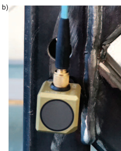
Photo 3. Structural dynamical system (a) analyzer; (b) accelerometer [Photo: authors] Fot. 3. System dynamiki konstrukcji (a) analizator; (b) akcelerometr
