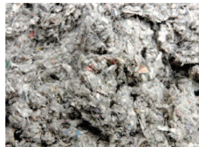
Fot. 2. Próbkę celulozy przygotowaną przez wdmuchiwanie materiału do formy – jednorodna mieszanina wypełnia całą pustą przestrzeń
