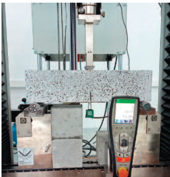
Photo 2. Test stand for determining the critical values of concrete fracture mechanics parameters Fot. 2. Stanowisko badawcze do wyznaczenia krytycznej wartości parametrów mechaniki pęknięcia betonu
