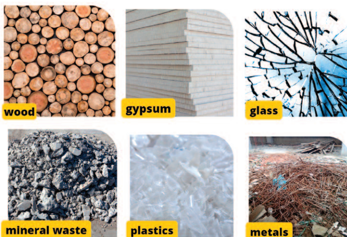
Waste fractions recommended for selective collection on construction sites Fracje odpadów wskazane do selektywnej zbiórki na budowach
