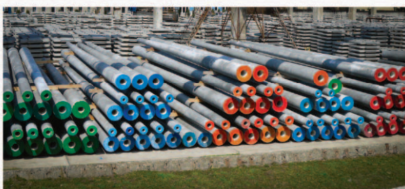
ZAKŁAD BETONÓW W KOLBUSZOWEJ - ŻERDZIE WIROWANE
