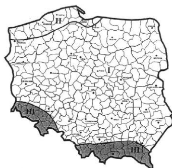
Fig. 3. Wind load zone map according to [10] Rys. 3. Mapa stref obciążenia wiatrem wg [10]
