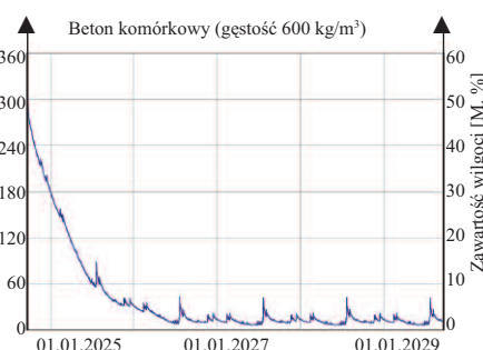
Rys. 2. Poziom wilgotności w betonie komórkowym w przypadku przegrody z pozostawionym tynkiem cementowo-wapiennym – wariant 3
