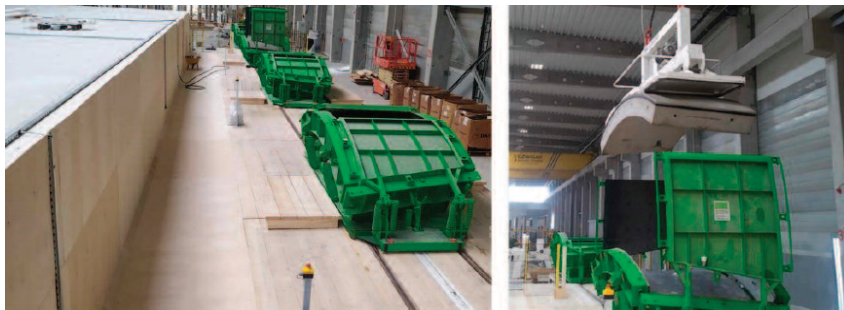
Fot. 2. Linia technologiczna produkcji tubingów w zakładzie PEKABEX w Mszczonowie Fot. PEKABEX
